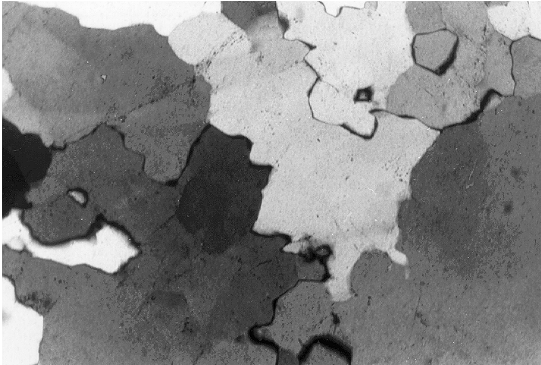
Εικ. 3.14. Δυναμική ανακρυστάλλωση από μετανάστευση των ορίων των κόκκων.
